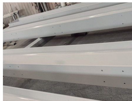
Viga pintada com Primário Epoxi EP15-700 HS
