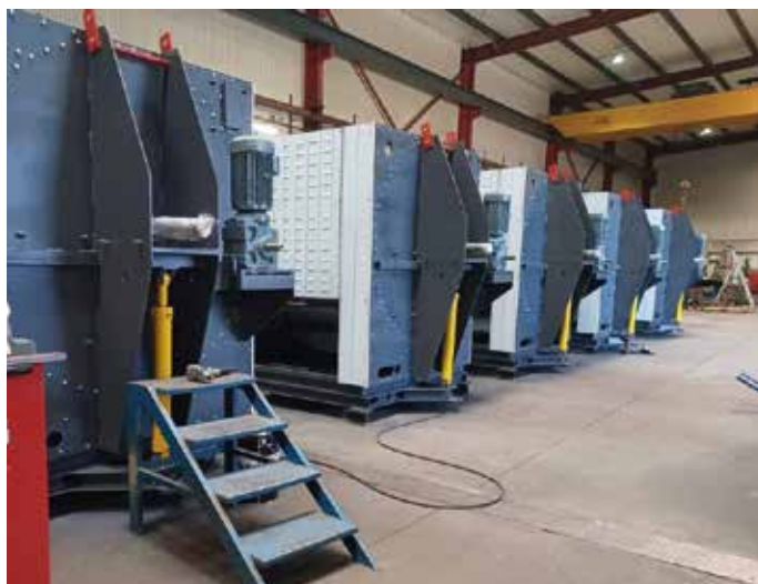
Obra: Equipamentos de Lavandaria e Tinturaria Industrial // Localidade: Vila Nova de Famalicão // Produtos: Primário Epoximar + Tinta Epoxilina Granulada + Esmalte PU + Esmalte SR // Cliente: JMC Laundry Systems - José Maria Araújo Campos, Lda. // Comercial: Carlos Oliveira
